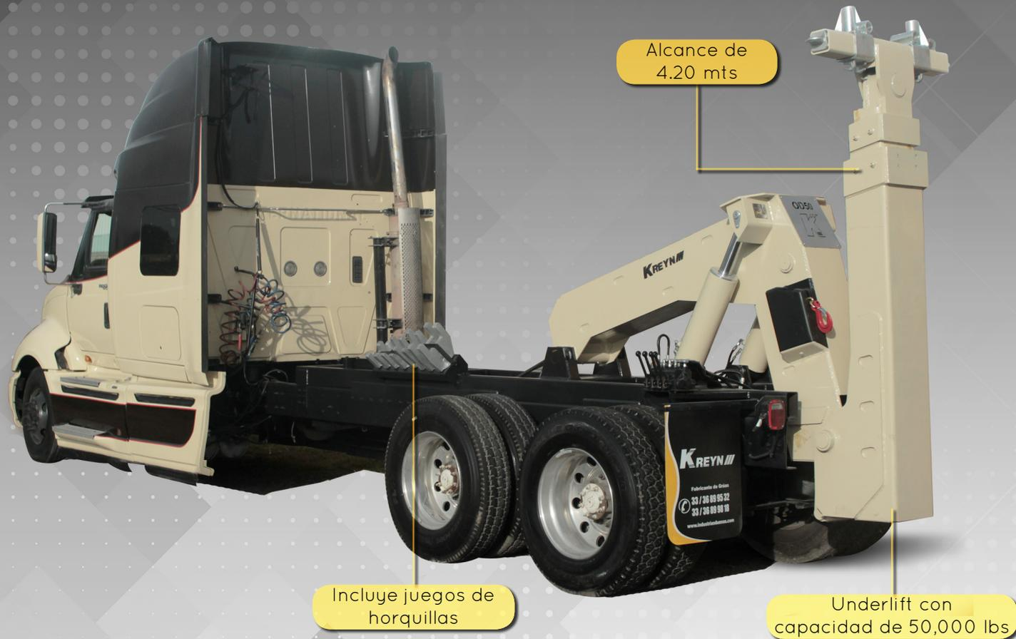
Un equipo de grúa diseñado para no dejar ir nada de trabajo, debido a que cuenta con la combinación perfecta de capacidad y gran longitud en alcance que le permiten levantar un autobús por los ejes sin preocupación alguna.
